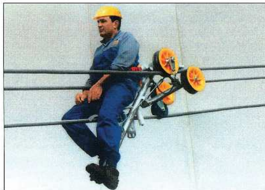
Mod. BCN 038/3 BICICLETA PARA CONDUCTORES HAZ TRIPLE Peso: 38 Kg. Carga útil: 100 daN
