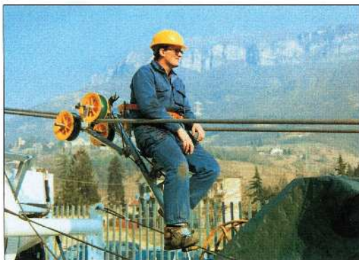
Mod. BCN 038/2 BICICLETA PARA CONDUCTORES HAZ DOBLE Peso: 32 Kg. Carga útil: 100 daN
