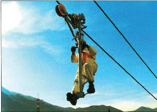
Mod. BCN 038/1 BICICLETA PARA CONDUCTOR SIMPLE Peso: 25 Kg. Carga útil: 100 daN
